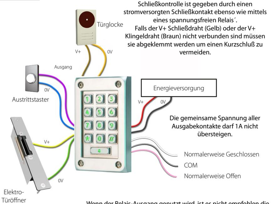
Wenn der Relais-Ausgang genutzt wird, ist es nicht empfohlen die Schließkontakte mit Ruhestrom zu betreiben.
