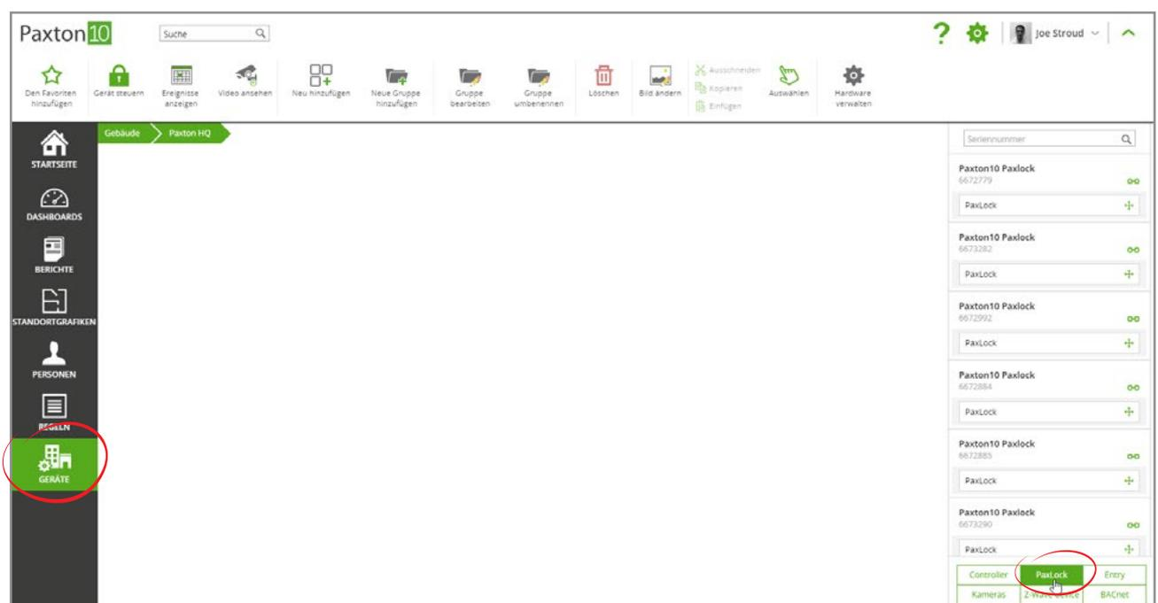
4. Klicken Sie auf das Verschieben-Symbol unter dem PaxLock Pro, welches Sie Ihrem System hinzufügen möchten, und schieben Sie es auf einen leeren Bereich des Bildschirms ab, um ein neues Systemgerät in Paxton10 zu erstellen, oder Sie schieben es auf ein vorhandenes PaxLock Tür-Gerät, um das PaxLock Pro dem bereits angelegten Gerät zuzuordnen.
