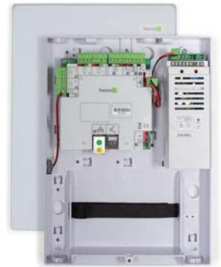
Tür-Controller - 12V 2A Netzteil Art.-Nr. 010-751-D
